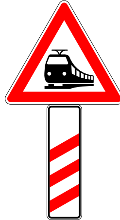
dreistreifige Bake (rechts) - vor unbeschränktem Bahnübergang -
