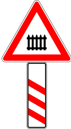
dreistreifige Bake (links) - vor beschränktem Bahnübergang -
