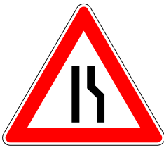
Einseitig (rechts) verengte Fahrbahn
